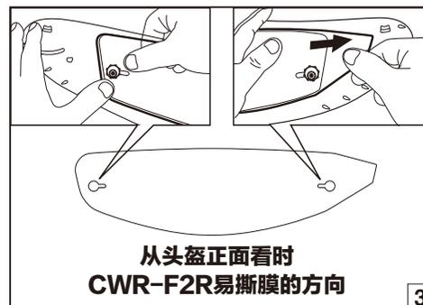
2 CWR-F2R易撕膜没有足够紧贴时，向逆时针方向（图4）旋转左右的按扣，绷紧CWR-F2R易撕膜的张力使其紧贴镜片。
