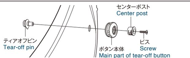
CWR-F2Rシールドに取り付けられているCWR-F2Rティアオフボタンのボタン本体を反時計回りに回し、図1のようにシールド正面から見てセンターポストが下に来るように調節します。
