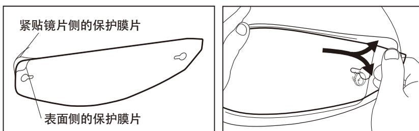
5 用毛巾等往外挤出CWR-F2R易撕膜与镜片之间的气泡，使其更紧贴住镜片。然后，除去表面侧的保护膜片。
