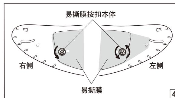
3 调节张力后，一旦将CWR-F2R易撕膜从镜片上拆下，再次清除附着在镜片表面的灰尘和油分。
