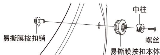
将安装着CWR-F2R镜片的CWR-F2R易撕膜按扣的按扣本体向逆时针方向旋转，进行调节，如图1所示，使中柱从镜片正面看时处于下方。
