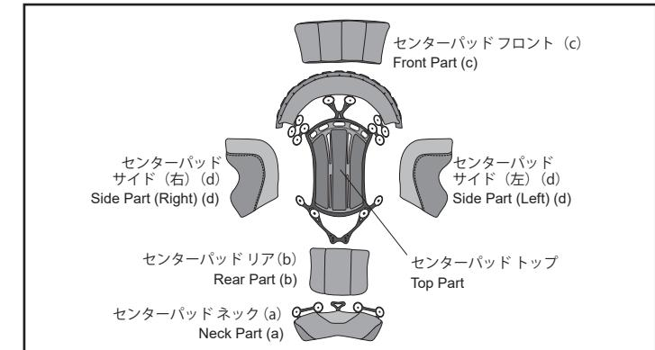
センター・パッドは、センター・パッド・トップ、センター・パッド・ネック (a)、センター・パッド・リア (b)、センター・パッド・フロント (c)、センター・パッド・サイド (d: 左右各1つ) の6つのパートで構成されています。
