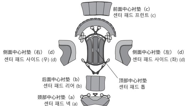
中心衬垫由顶部中心衬垫、颈部中心衬垫(a)、后面中心衬垫(b)、前面中心衬垫(c)、侧面中心衬垫(d: 左右侧各1个) 6个部件构成。
